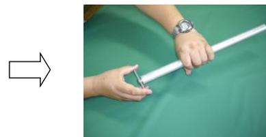
Tポットもしくはパイプを時計周りに廻して動かなくなるまで締め付けて下さい
